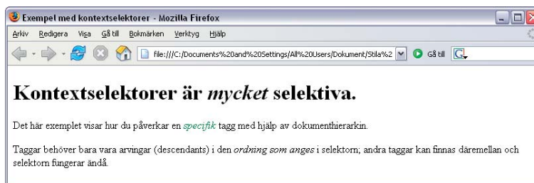
Figur 2.8 En barnselektor gör det möjligt att välja ut enbart ordet ”specifik” i den här koden.
