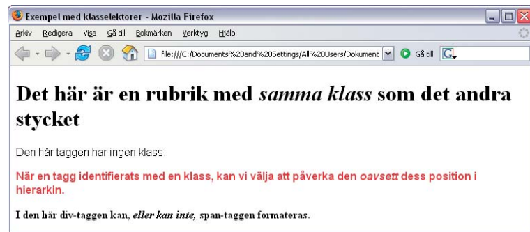
Figur 2.13 Ju mindre specifik selektorn är, desto större risk att andra taggar påverkas på ett sätt som inte var meningen.
