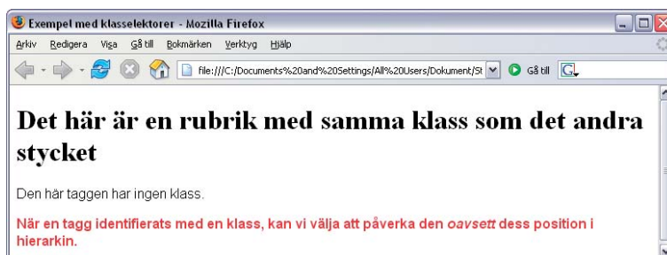
Figur 2.11 Genom att lägga till en andra selektor, kan man ännu mer exakt bestämma vilken tagg som ska formateras.
